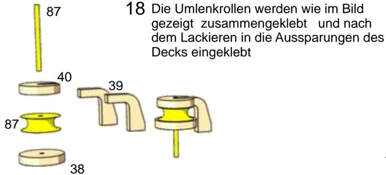
**18** Die Umlenkrollen werden wie im Bild gezeigt zusammengeklebt und nach dem Lackieren in die Aussparungen des Decks eingeklebt
